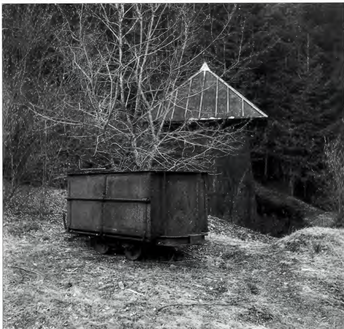
Hinter der Feldlore (mit Bremse und seitlicher Entleerungsklappe) befindet sich der hölzerne Aufbau der zum Schutz des Entlüftungstollen diente.
