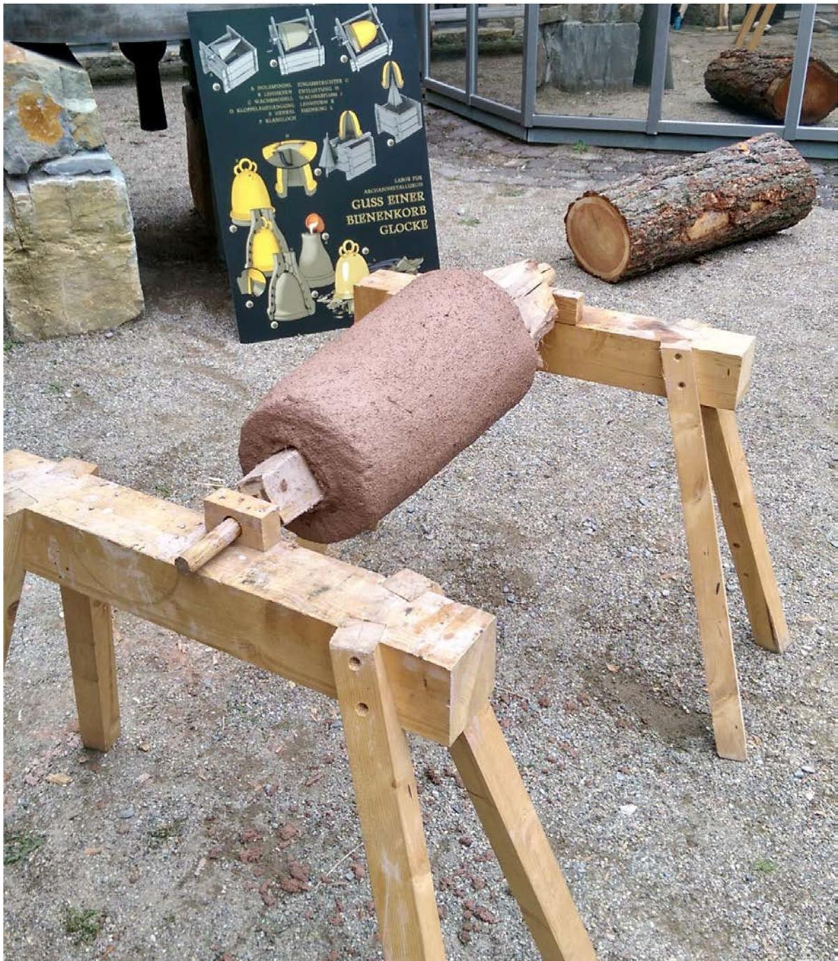
Abbildung 1: Der Arbeitsplatz mit der Drehlatte und der Spindel. Hier mit angefangenem Lehmkern.
