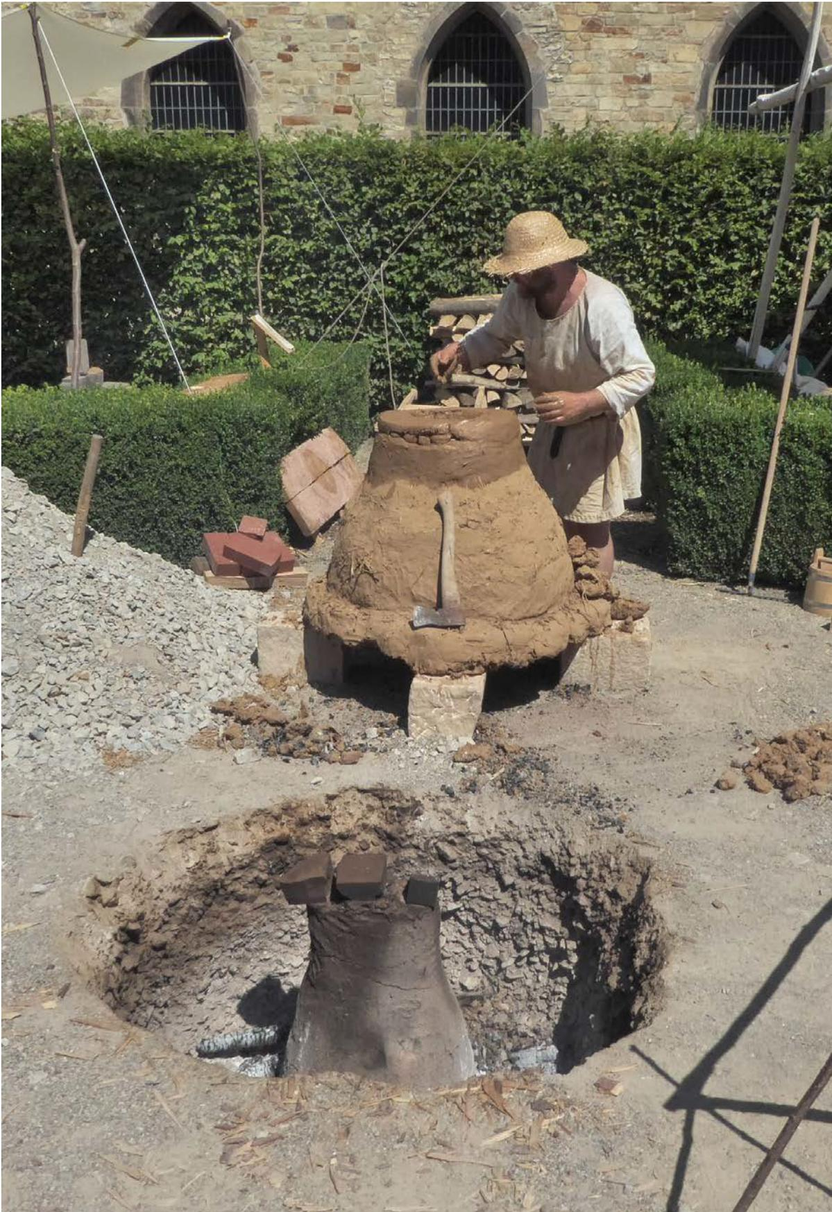
Abbildung 16: Der Schmelzofen; im Vordergrund die gebrannte Glockenform.
