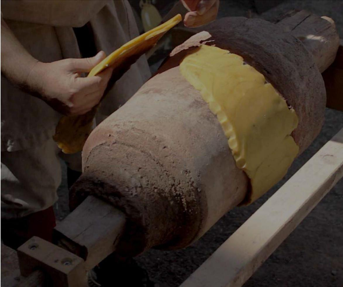
Abbildung 5: Auflegen der Wachsplatten beim Herstellen des Glockenmodells.
