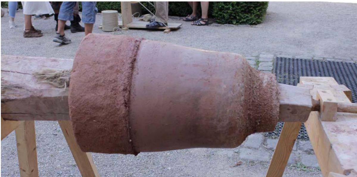
Abbildung 3: Der fertig gedrehte Lehmkern.
