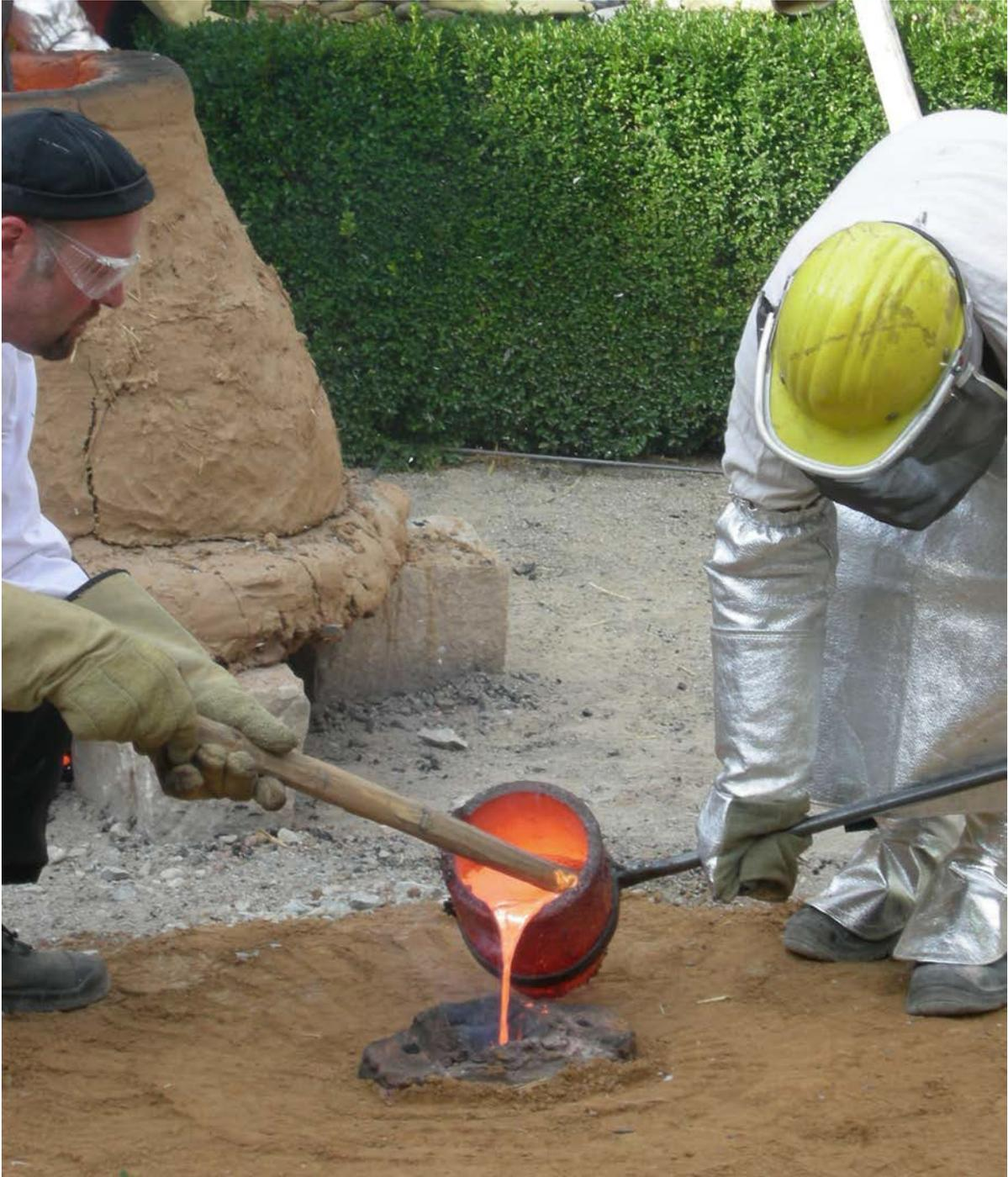
Abbildung 18: Guss der Glocke.
