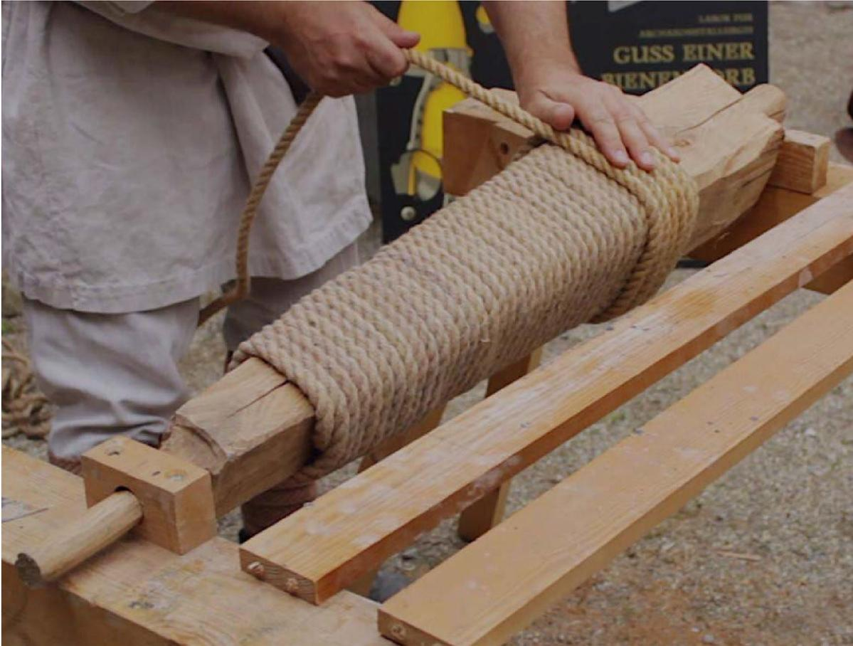
Abbildung 2: Auf die Spindel werden einige Lagen Seil als Schlupf gewickelt.
